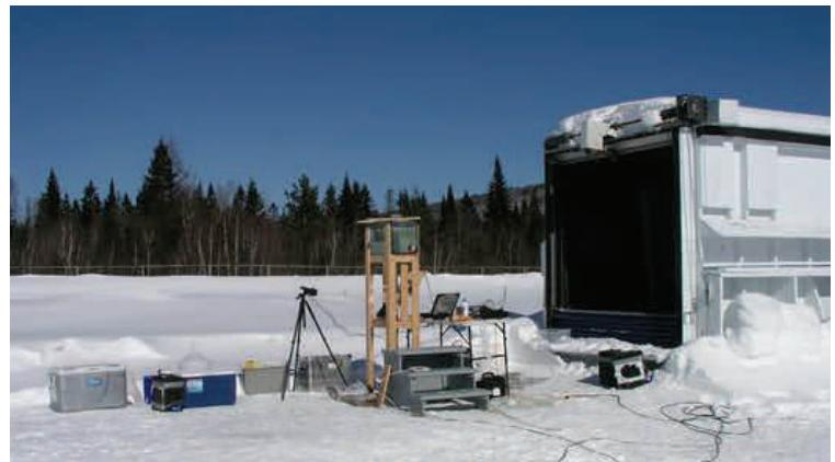
Evaluation d'un dispositif de détection de glace par Lidar
