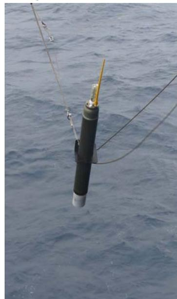
Mise à l'eau d'un flotteur Argo
