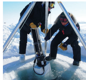
Figure 4 : Test captif d'un profileur ProIce au camp de glace de Qikiqtarjuaq. Crédit photo : Claudie Marec.
