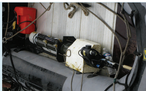
Figure 14 : Un des flotteurs Bio Argo récupéré dans la Mer Ionienne, après 2 ans de vie.
