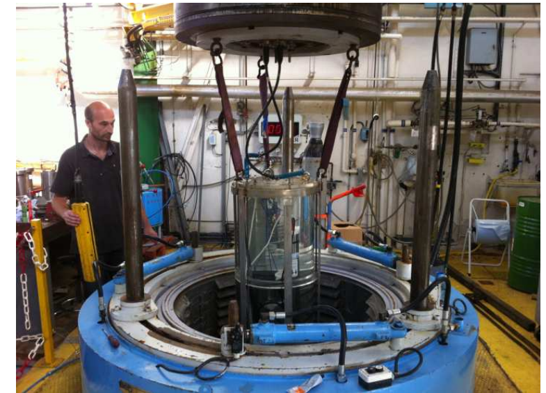
Capteur NOSS V2.2, lors des essais pression
