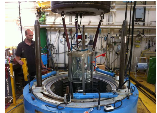
Capteur NOSS V2.2, lors des essais hyperbares à l'Ifremer
