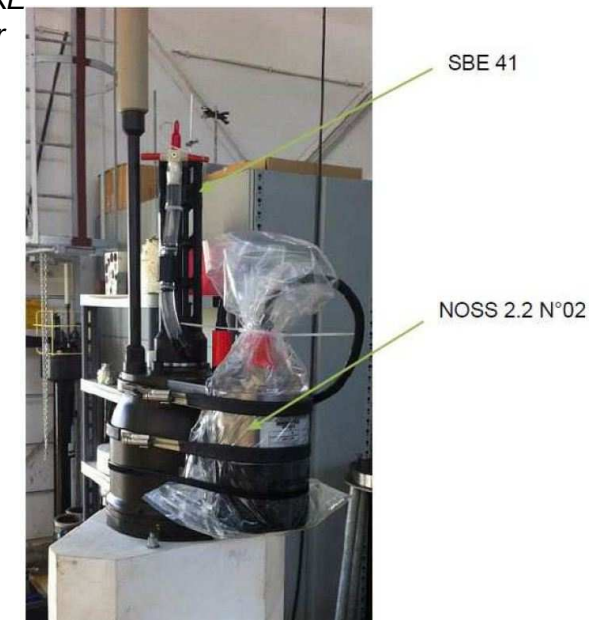
Montage du Noss sur le Provor CTS4
