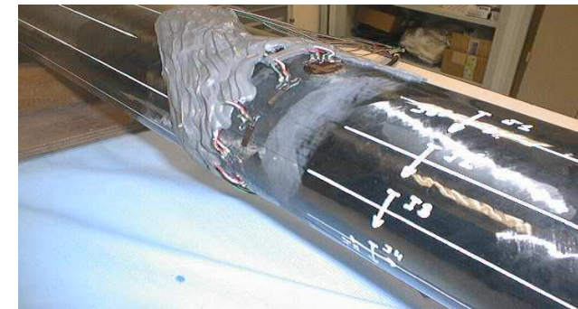
Instrumentation par jauges du tube composite
