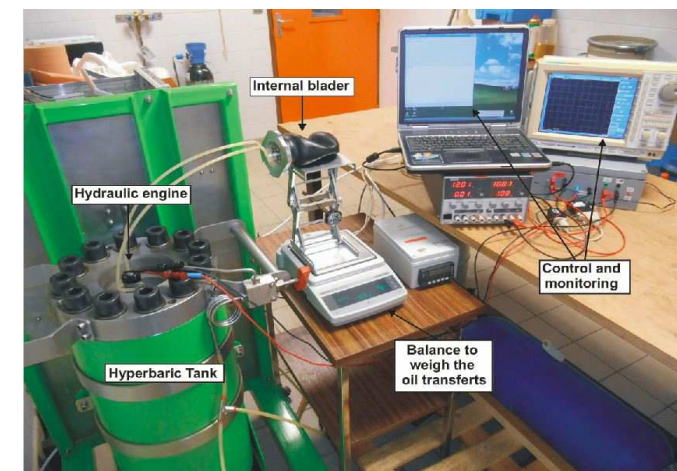
Banc de test hydraulique
